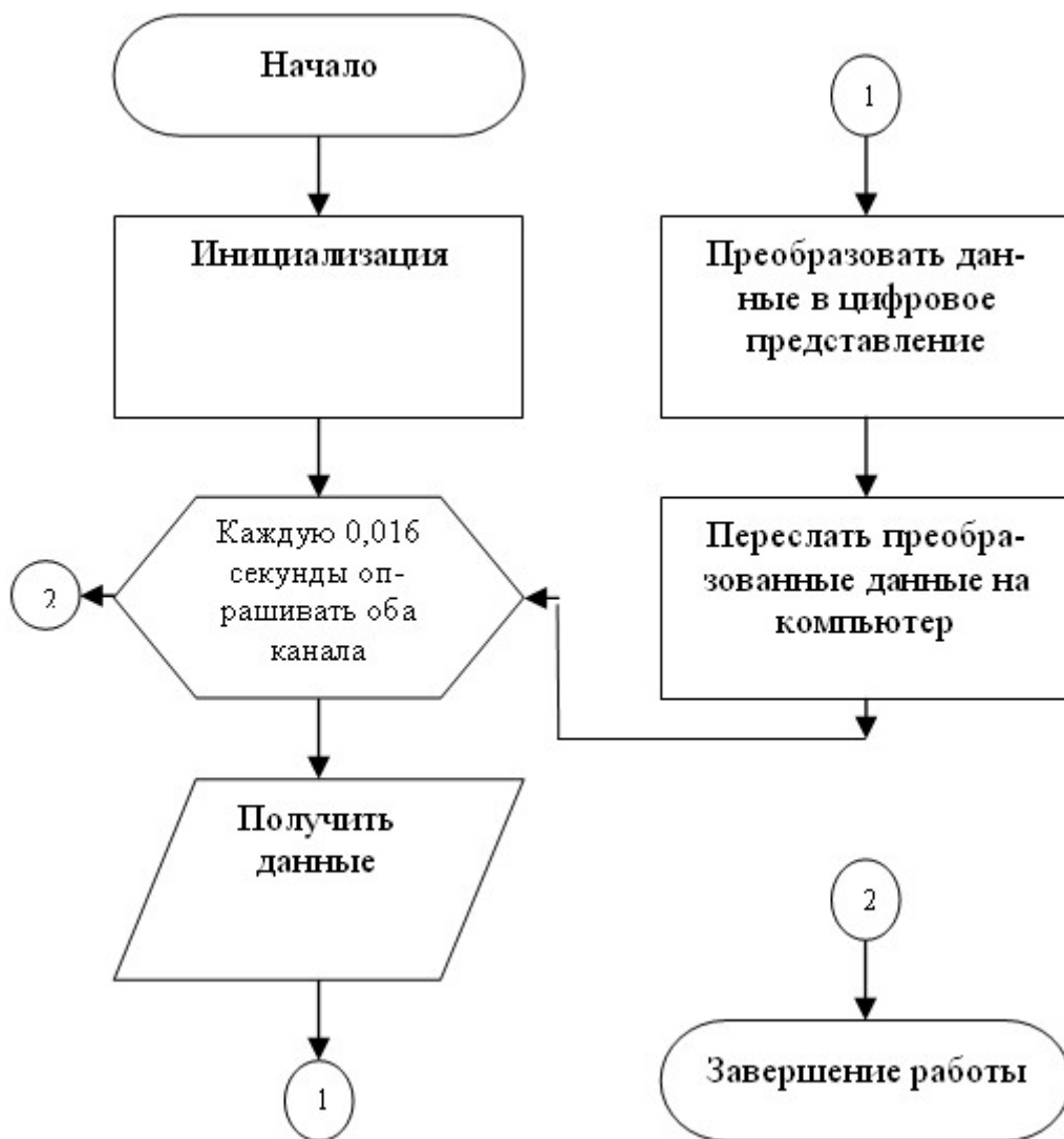
Рис. 2 – Блок-схема программы микроконтроллера PIC
